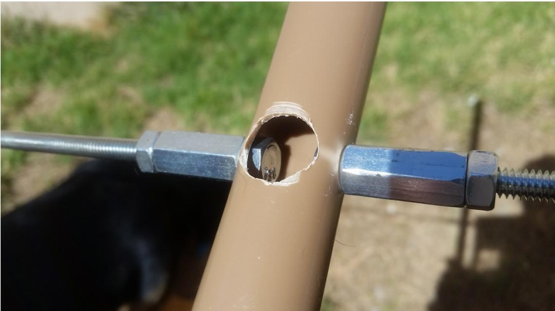
Os prolongadores tem a dupla função de fixar a barra roscada aos parafusos internos, e também fixar a malha e o condutor central do cabo da antena.
