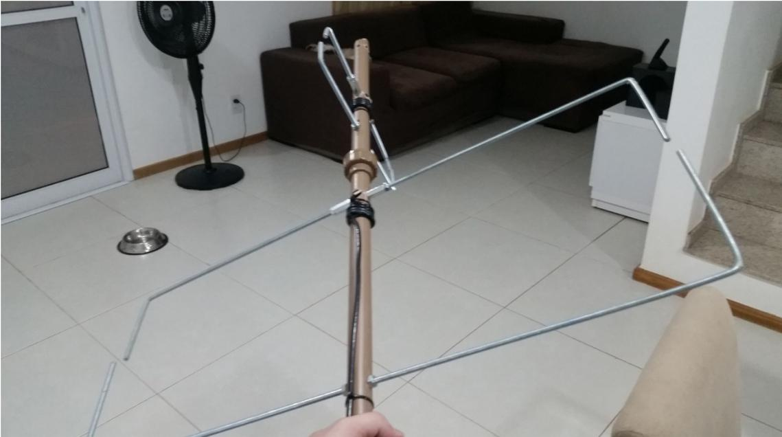
Através da união de PVC rosqueada, conecta-se uma antena a outra em quadratura (90 graus), assim a polaridade de uma não interfere na outra.
