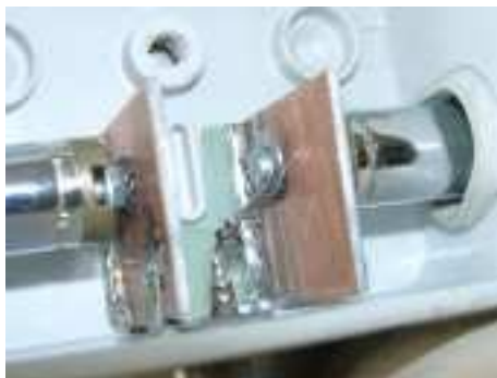
Particolari isolatore realizzato con vetronite ramata su entrambi i lati ed opportunamente sagomata
