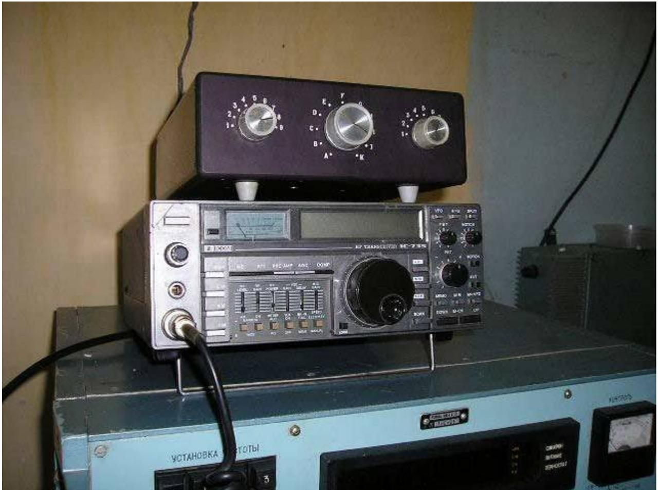
Проверку и испытания готовой конструкции желательно производить при 10-20 ваттах мощности, на эквивалентных резисторах 15 ом и 200 ом. Указанные эквиваленты можно изготовить самому из набора резисторов МЛТ-2w. Для контроля согласования используется встроенный КСВ метр трансивера.
