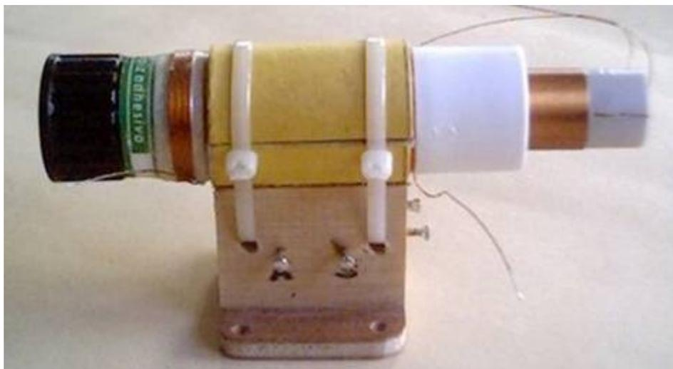
Un sistema pratico, economico e funzionale per realizzare un accoppiatore variabile per bobine, già usato nella Radio a reazione presente nel sito, consiste nell'utilizzare un tubetto vuoto di colla per ufficio; per intenderci lo stick che, con la rotazione della base inferiore, aziona un cilindretto di colla solida che fuoriesce dal contenitore.
