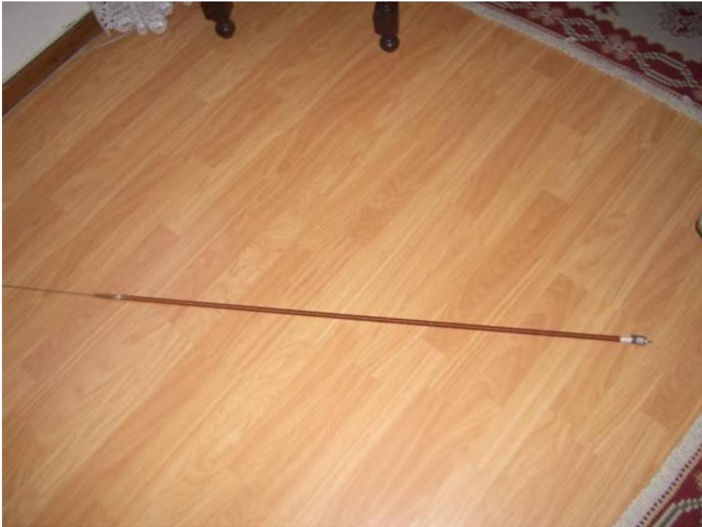
Antena com a ficha PL colocada na base, com a péça de latão posta na parte superior para afinação da frequência de tx, enrolamento espiras de fio á volta do tubo de fibra de 8m/m de diametro
