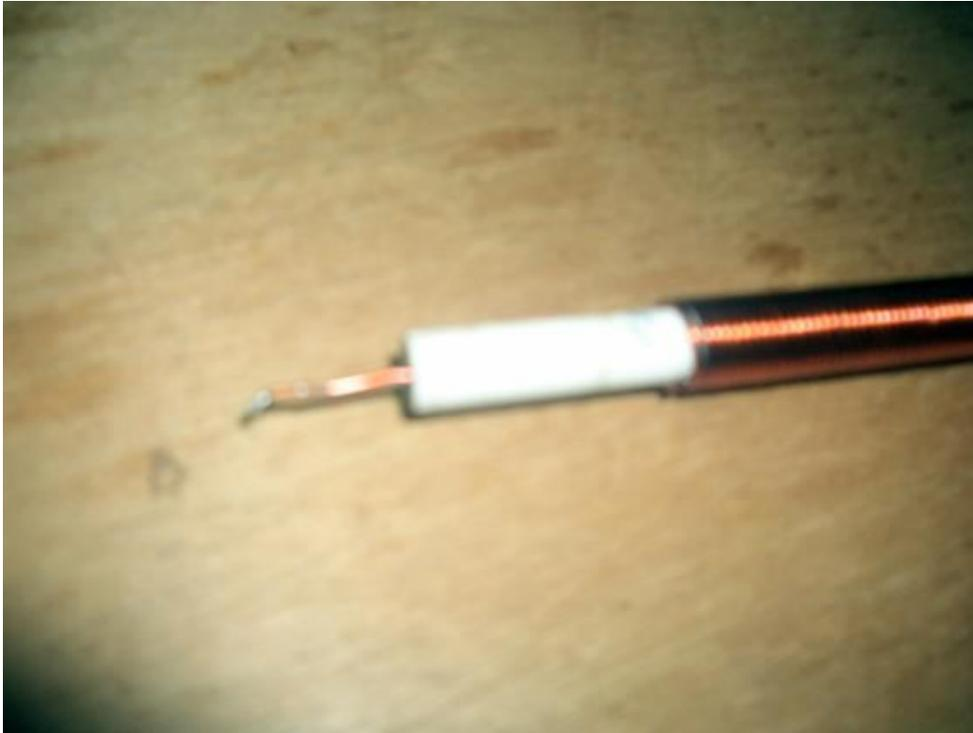
Tubo de fibra com o fio a sair para encaixar a PL e soldar o fio ao vivo.
