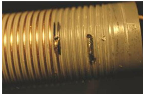
torcido. A profundidade desta ranhura pode ser apenas 0,5 mm. os enrolamentos 162 são de uma distância de 48 centímetros. O passo é, 8 voltas por 2,54 cm (1 polegada). O fio de enrolamento é de calibre 16 (calibre 16 = 1,5 mm<sup>2</sup>, que é o nosso fio preto).
