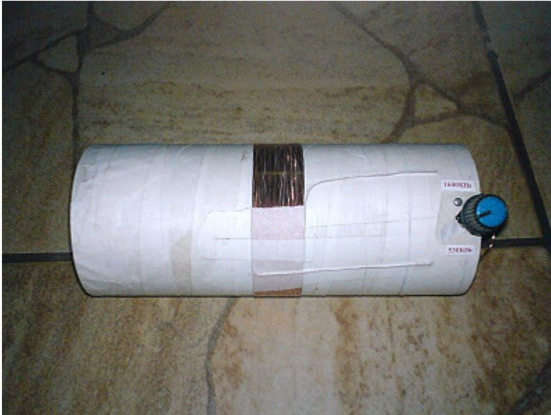
Eu não dei um melhor acabamento porque pretendo experimentar mais modificações, então ficou assim mesmo. Modifiquei também a posição do capacitor variável e aproveito para corrigir o valor que é de 410pF. O tubo utilizado possui diâmetro externo de 3 1/4 pol. [8,2cm] e 20cm de comprimento, foi usado o mesmo número de espiras, 38, para cobrir toda a faixa de 530KHz a 1600KHz.
