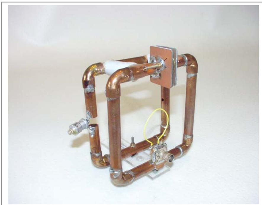
Dans la 1<sup>ère</sup> partie précédente, nous avons décrit un modèle carré d'antenne cadre magnétique 144 MHz. émission-réception.
