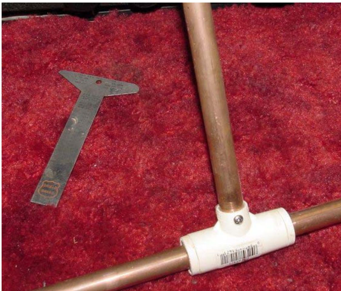
A grande (04/03 ") parte é usada, e adaptado para caber a tubulação de água, para aumentar suas qualidades isolantes, como há muito alta tensão neste ponto. Uma tira de latão ou de cobre 1 / 2 por 3" aparafusado à parte fora do meio do Tee CPVC, através de um buraco pequeno centro, e é girada uma forma ou de outra como um sintonizador de ressonância (Butterfly). Quando o Butterfly é perpendicular ao elemento, a frequência é maior, quando paralela, é mais baixo.
