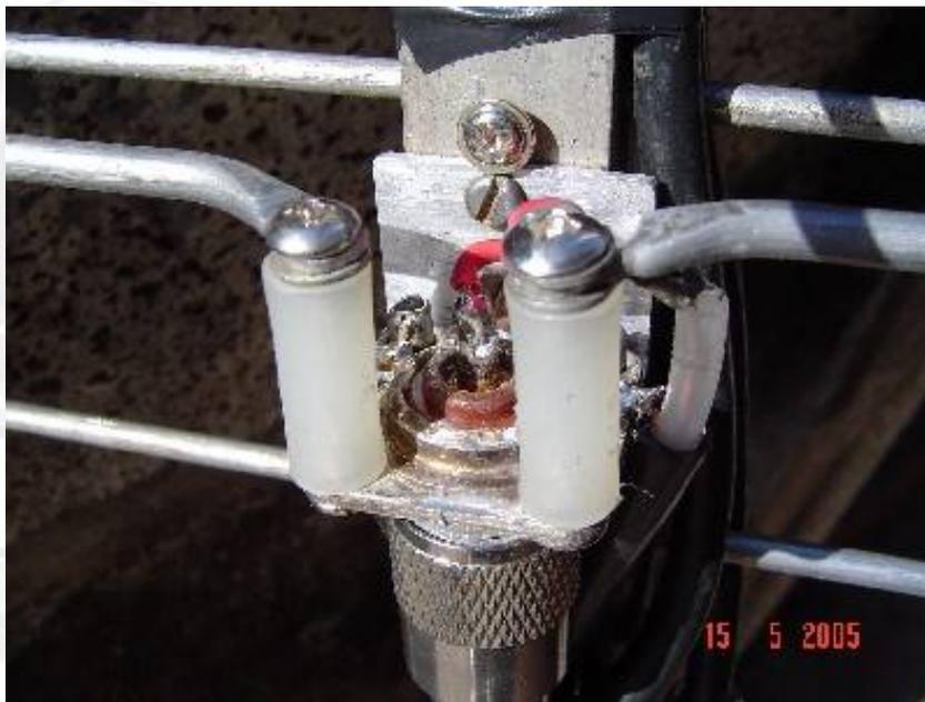
A distancia que o braço deve ficar do elemento é de 23mm, por isso temos a curva no braço do t-match, para que ele fique a esta distancia. Com um alicate, ajuste essa curva para que o braço fique a esta distancia do elemento EA.
