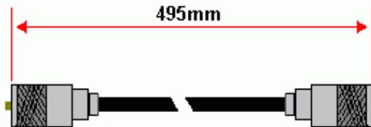
As medidas dos splitter devem ser contadas inclusive os conectores, conforme acima. Se você não tiver como fazer as medidas que expliquei acima, recomendo usar  $495mm$  e torça para seu cabo ser da mesma marca que eu utilizei.
