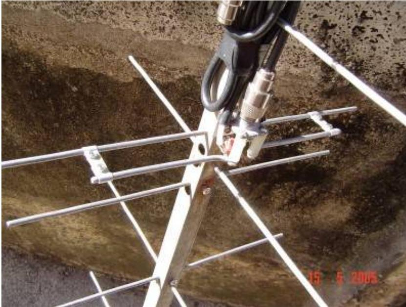
Os inconvenientes do t-match é que temos dois ajustes em cada antena e devemos ter especial atenção ao balun de 4:1 feito com cabo de RG59 ( $75\Omega$ ). Usaremos cabo fino por ser mais maleável, já que o RG11 (vulgo  $75\Omega$  "grosso") é muito rígido para uma antena tão pequena, e não há necessidade se se utilizar um cabo que suporta até 1Kw!
