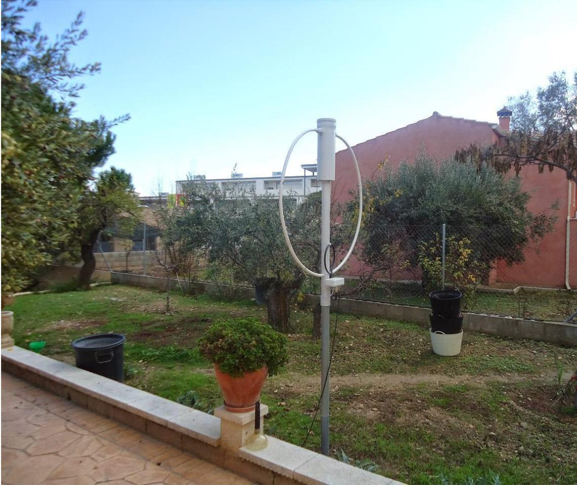
Antena de  $\varnothing 88\text{cm}$  para cubrir de 20 a 10m en sintonía continua. Una de mis antenas.
