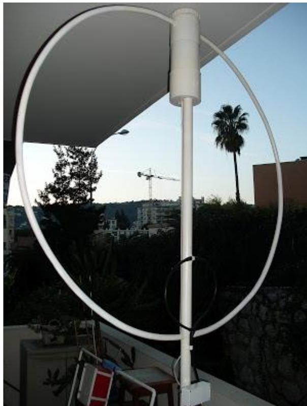
Antena del amigo Adolphe-F1SPK en una terraza cubierta. En este caso, el aro es de  $\text{Ø}1.40\text{m}$  realizado con tubo de  $\text{Ø}22\text{mm}$ .
