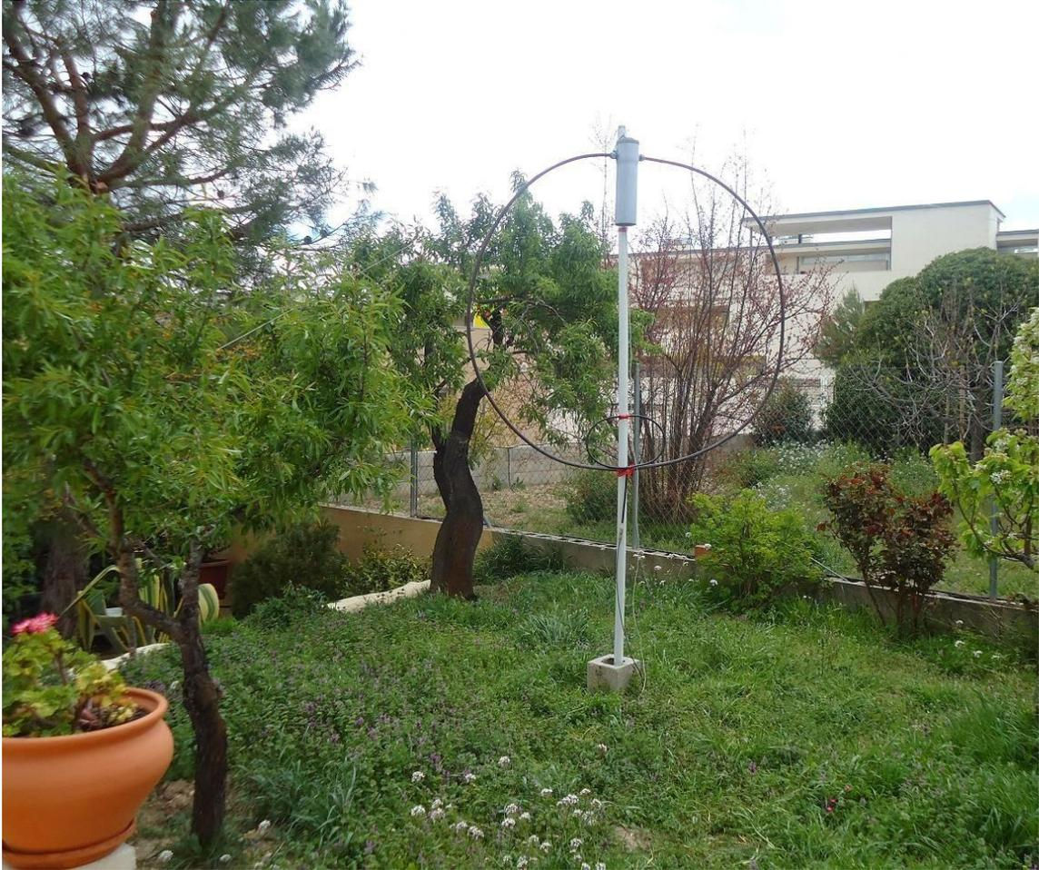
Antena de  $\varnothing 1.70\text{m}$  para cubrir de 40 a 20 con sintonía continua. Una de mis antenas.
