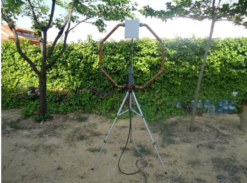
Antena de  $\varnothing 88\text{cm}$  octogonal para cubrir de 20 a 10m en sintonía continua. Una de mis antenas.
