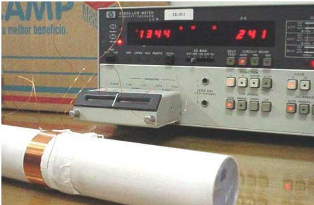
Figura 2A - Detalhe da montagem da bobina que forma o indutor (\*)
