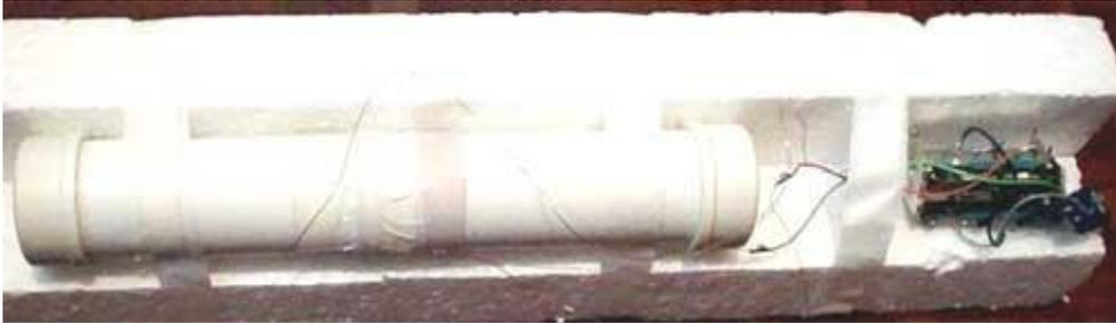
Figura 3A - Detalhe da montagem do capacitor variável em paralelo com a bobina (\*)
