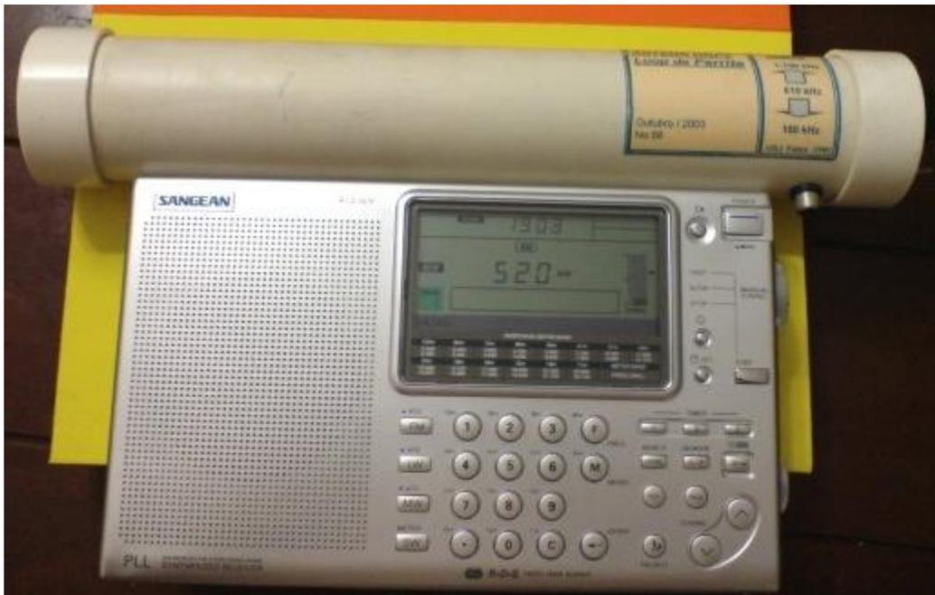
Figura 4 - Receptor Sangean acoplado a antena Loop RGP3 através da proximidade ( indução )
