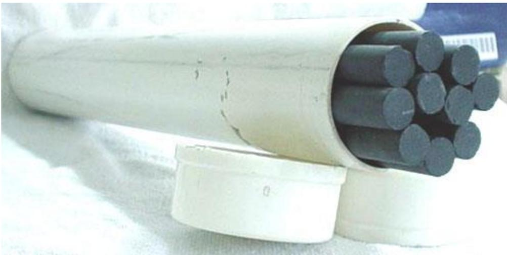
Figura 1A - Bastões de ferrite inseridos no tubo de PVC (\*)
