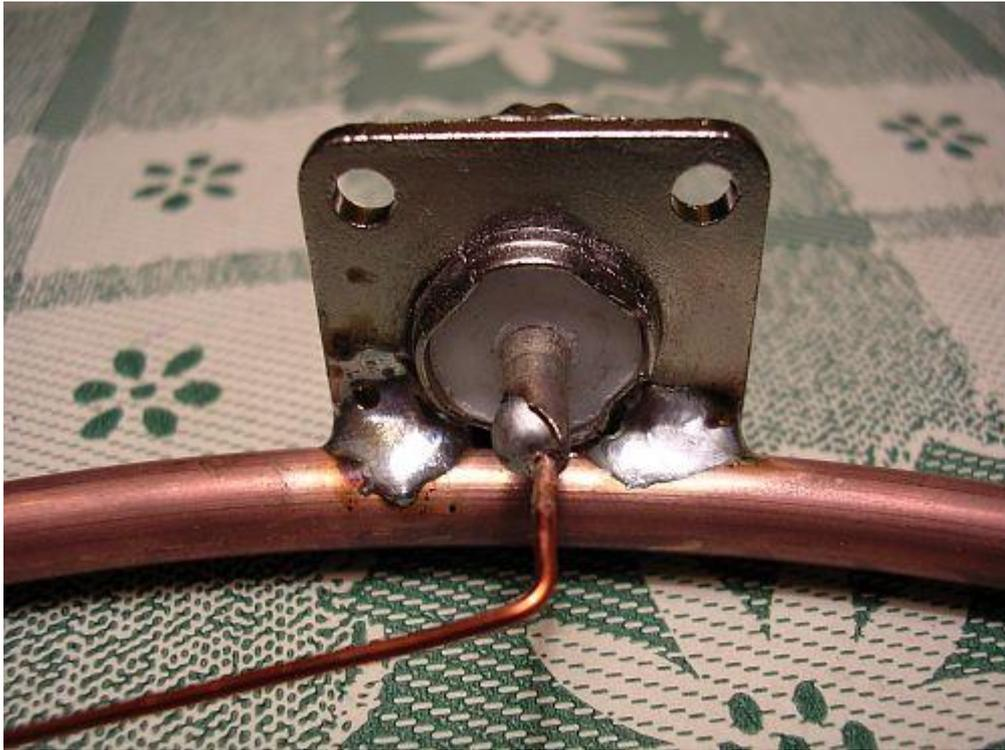
Em seguida, proceder para realizar o jogo de gama para o fornecimento de energia. O comprimento da faixa deve ser cerca de 7,7 cm e uma altura de 1,5 cm. Feito à medida que fornecer uma solda no meio do conector de um lado e circula no outro. Certifique-se de que o fio magnético para soldar deve ser levemente arranhado. razão Detalhe em gamma-match:
