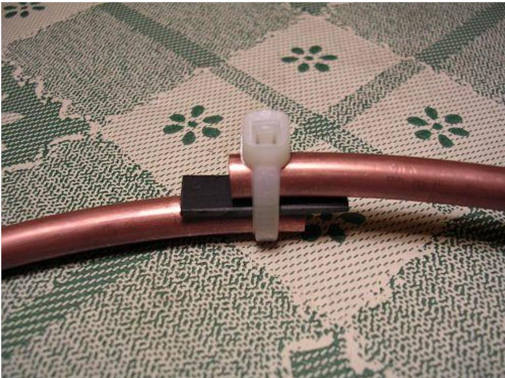
Então ... chegamos ao fim eo início de nossa malha magnética por 2 metros ... Se bem construída com bom espaçamento entre o condensador no topo da antena leva energia discreta (50 W). Aconselhável para um . uso de base magnética portátil ou um adaptador duplo PL259 absolutamente não tocar no circuito durante a transmissão e não se expor a longos tempos de irradiação em curtas distâncias. fotografias aéreas concluídos e calibrados:
