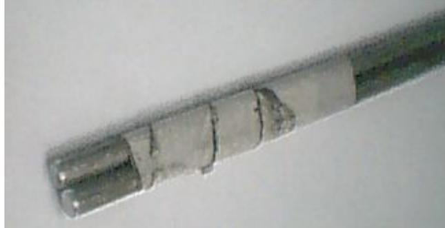
O boom ou gôndola, use preferivelmente alumínio de 20 x 20mm. O formato quadrado ajuda MUITO no alinhamento da antena. O comprimento total da gôndola é de 1,30 metros. Eu re-proveitei uma velha gôndola de uma antena de FM. Este alumínio tem uma parede bem fina, cerca de 0,7mm. Pode parecer fino a primeira vista, mas é o suficiente, e o importante, a antena fica muito leve!
