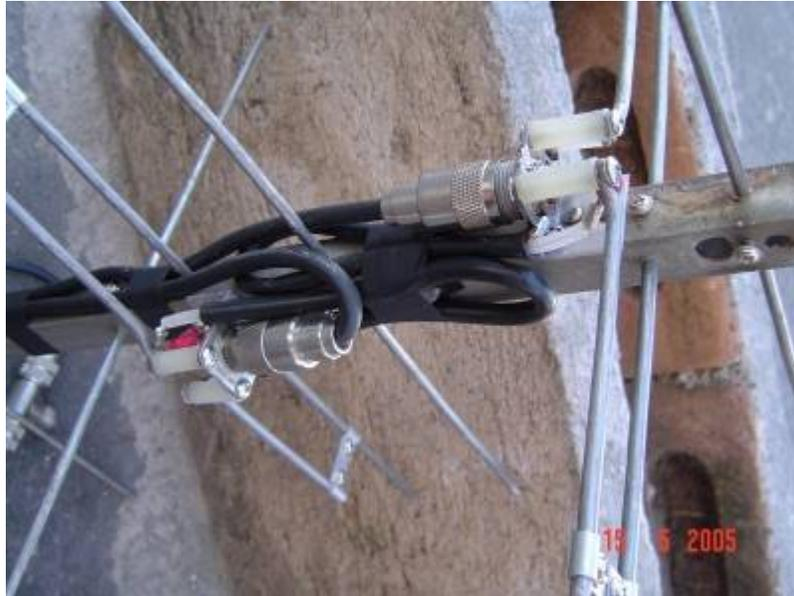
Os braços do t-match serão feitos com o mesmo vergalhão de alumínio usado para os elementos. Corte quatro pedaços de 100mm de comprimento. Amasse uma das pontas com um martelo de forma que fique igual a imagem abaixo. Faça um furo de 1/8" que será usado para a fixação do braço e entorte um pouco vergalhão conforme aparece na imagem. Faça isto nos 4 vergalhões.
