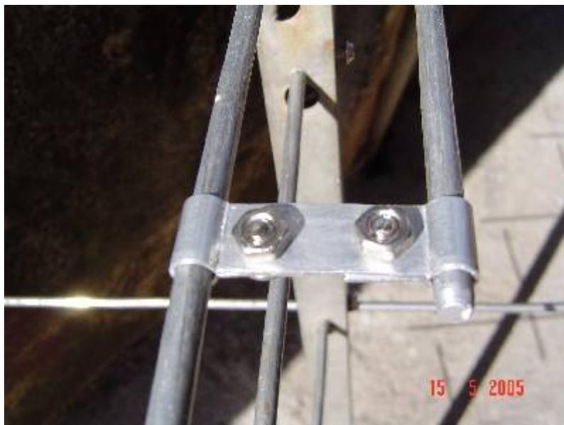
Agora ligue as pontas do cabo coaxial do balun aos braços do t-match, para isso, use terminais redondos de 3mm. Ao invés de prensar o fio de cobre, solde, é mais garantido. Solte também um fio bem curto ao terminal do conector e coloque um terminal em sua ponta.
