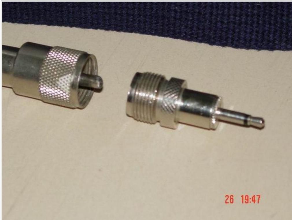
**Detalhe do conector PL-259 e do adaptador SO-239-Mini usado no Sony ICF-2010.**
