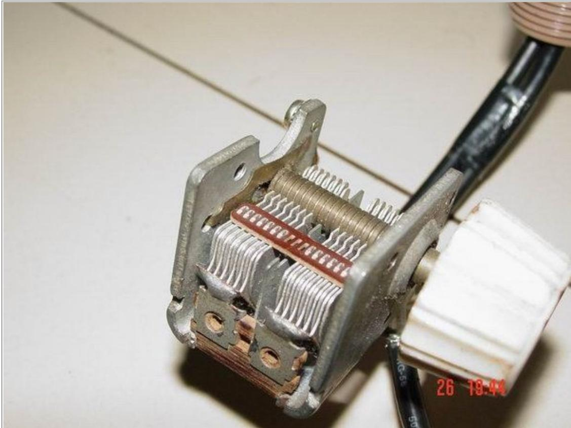
**Detalhe do capacitor variável usado para fazer a sintonia do circuito ressonante.**
