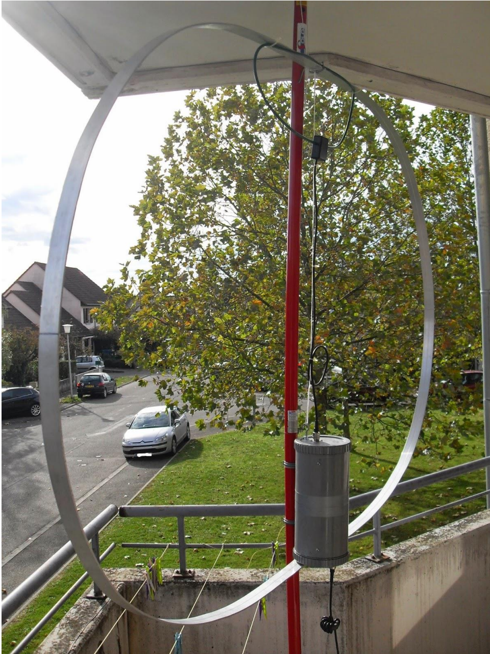
Loop de balcon version 80 à 30m
