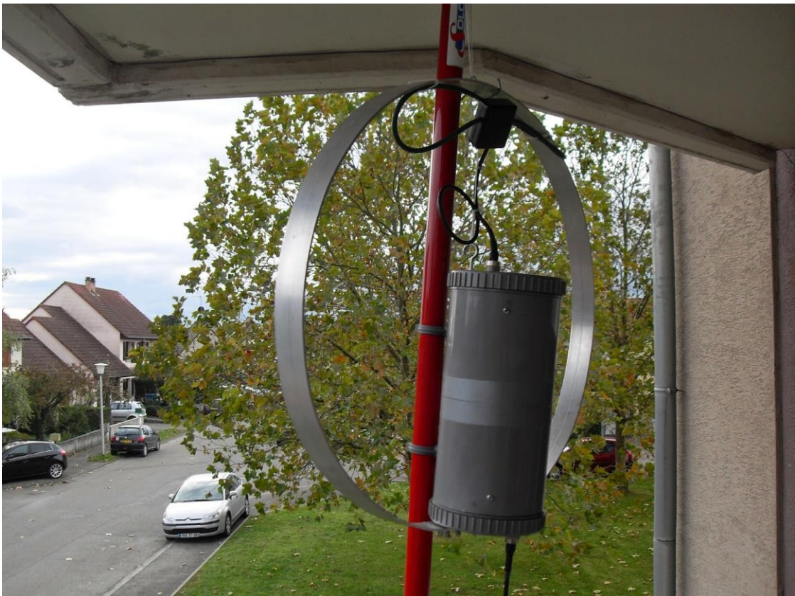
Loop de balcon version 40 à 10m
