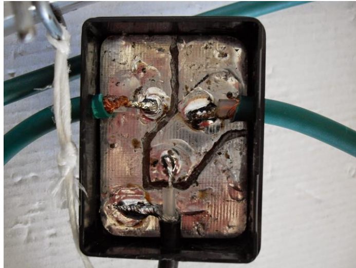
Connexion par CI de la boucle de couplage au coax 50ohm
