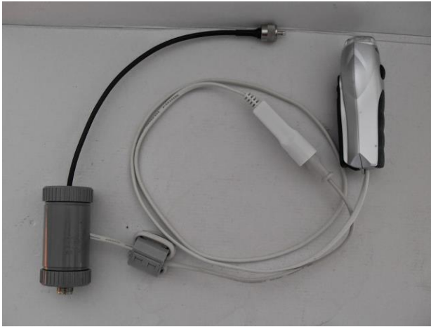
L'ensemble de commande duplexer RF/DC & lampe de poche
