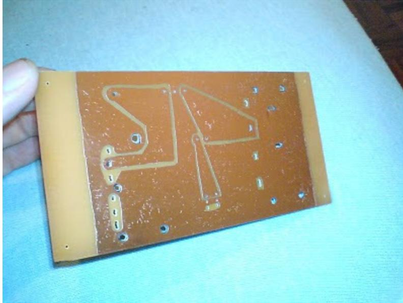
Esta é a placa que vai alojar os capacitores  $C_1$ ,  $C_2$  e  $C_3$ , o interruptor  $SW_2$  e terminais de ligação da bobina.
