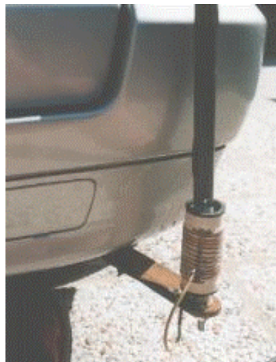
Figura 5 - Matching coil per cercare il migliore accoppiamento fra cavo coassiale e antenna
