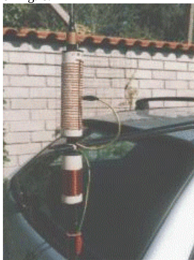
Figura 6 - Loading coil e bobina dei 40m
