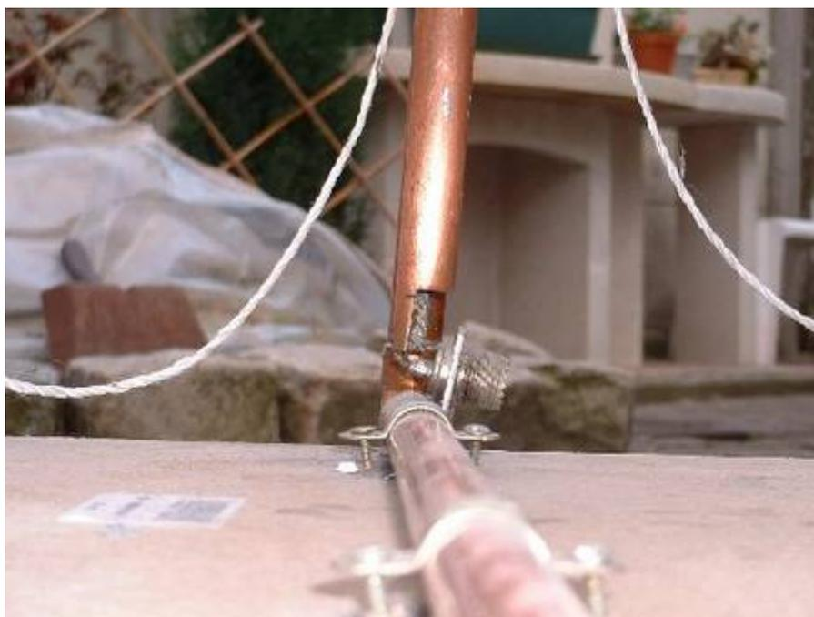
la soudure sur le cadre et sur le gamma.
