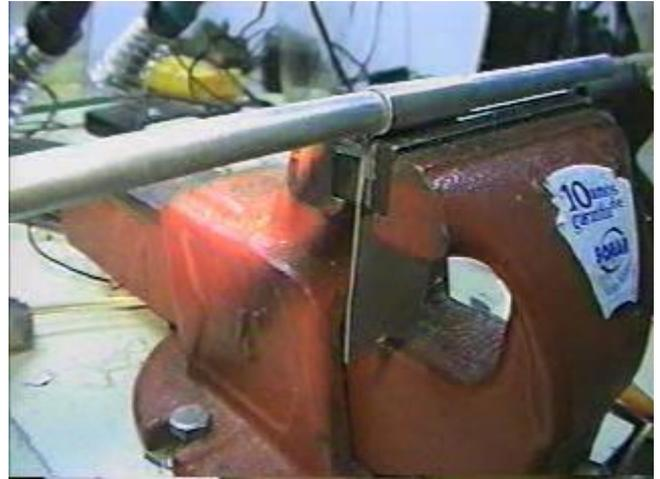
Moldando uma lâmina de alumínio para servir de "curto circuito ajustável" na regulagem do gamma match.
