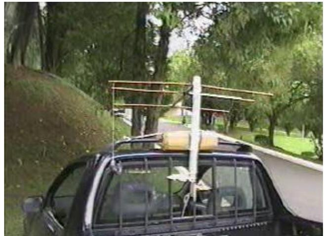
Instalação na pickup Corsa. A antena foi fixada a um cano de metal que serviu de "torre" giratória. O cano
