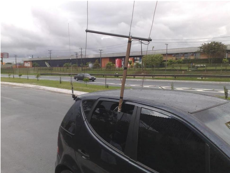
Foi utilizado um cano de PVC de 32mm como "mastro", dentro do qual inserimos metade do irradiante e o gamma. A ponta do PVC foi moldada para encaixe da gôndola, fixando-os com fita plástica.
