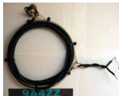
Slika 5. Collins balun 1:1, RG 58 C/U namotan u smotuljak
