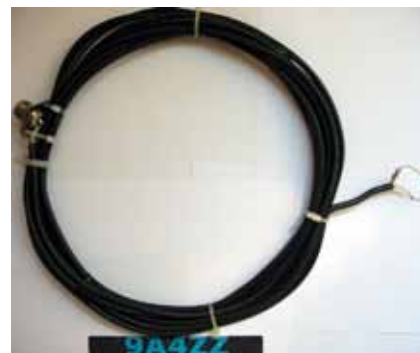
Slika 2. Choke balun 1:1, RG 58 C/U namotan u smotuljak
