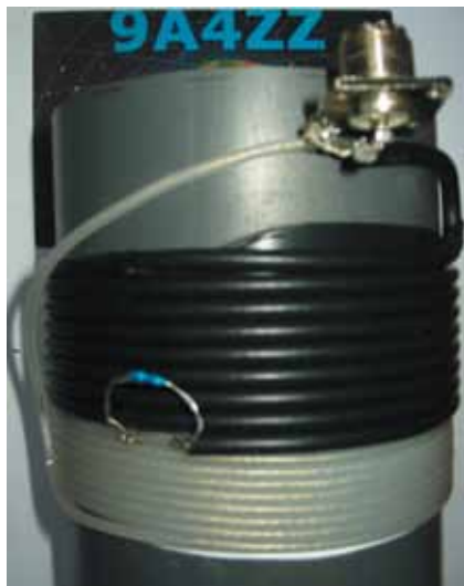
Slika 3. Collins balun 1:1, RG 58 C/U namotan na PVC cijev
