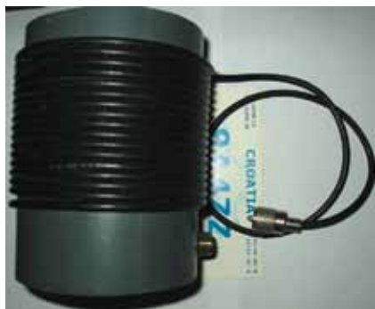
Slika 1. Ugly choke balun 1:1, RG 58C/U namotan na PVC cijev
