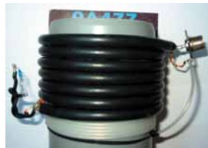
Slika 4. Collins balun 1:1, RG 213 namotan na PVC cijev
