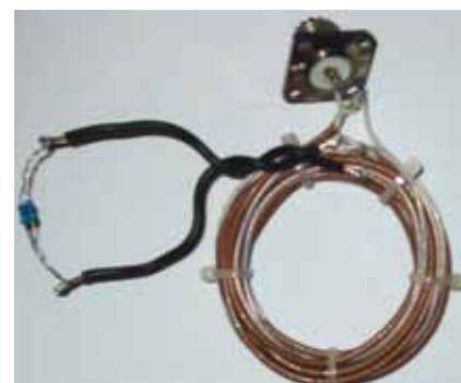
Slika 7. Collins balun 1:1, RG 316 namotan u smotuljak
