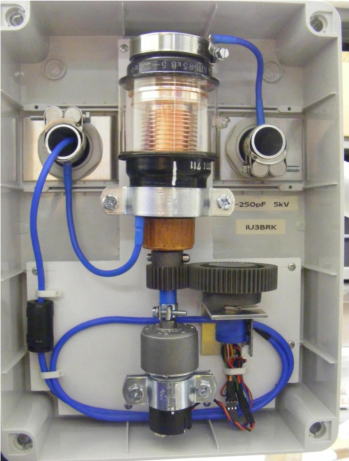
Il cavo di alimentazione del motore e del potenziometro corre all'interno del loop, in modo da non avere cavi "svolazzanti" e antiestetici che scendono dalla scatola del condensatore ed inoltre il tubo stesso fa da schermatura.
