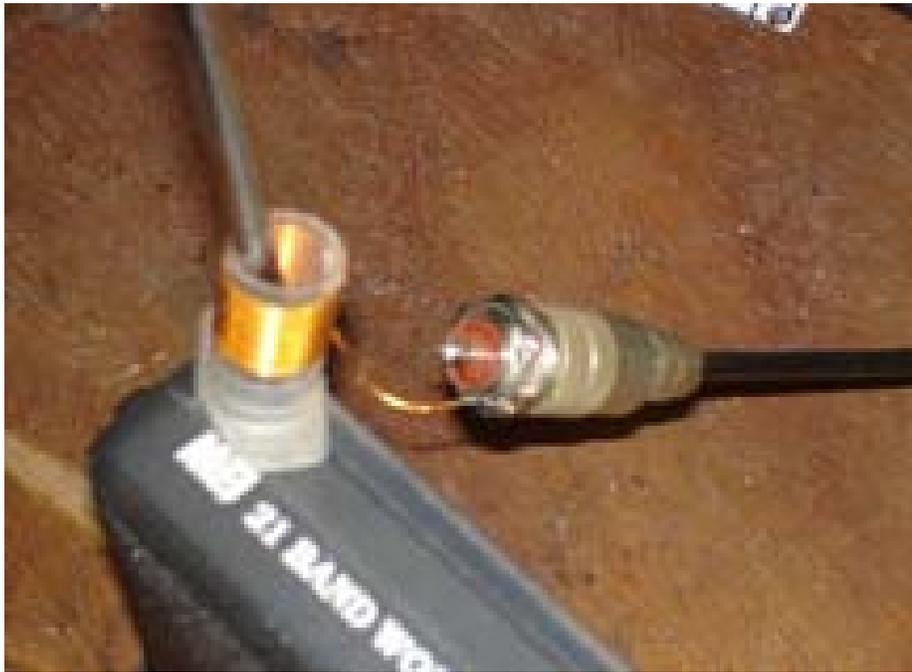
**Adaptador colocado na antena do Receptor**
