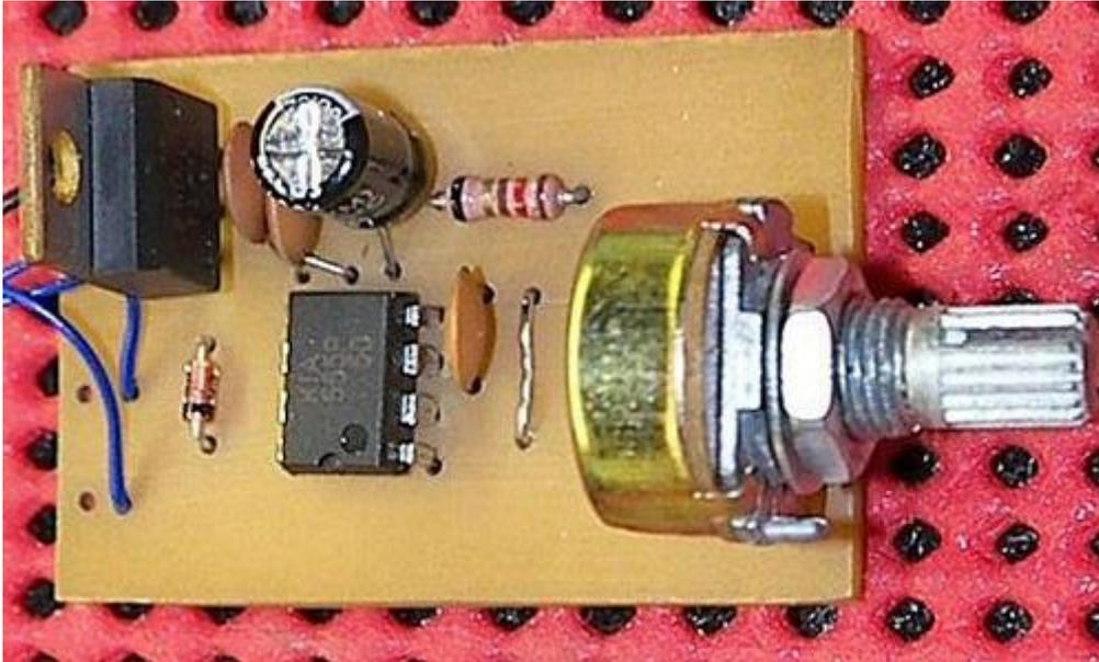
O conjunto motor com caixa de redução utilizado nesta antena trabalha com 12 VDC e tem velocidade de 4 rotações por minuto, esta velocidade é adequada para o ajuste primário do bloco de sintonia porém muito alta para o ajuste fino da frequência de ressonância que é regulada para o ponto mais adequado através do potenciômetro de 100K que define a velocidade lenta do ajuste.
