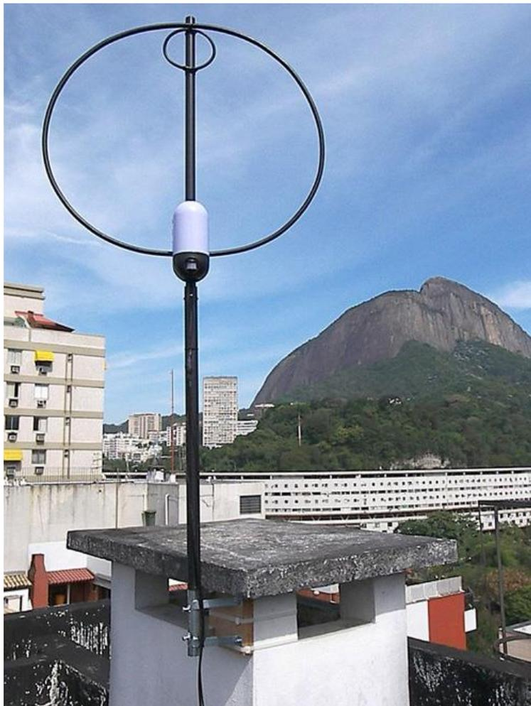
Antena loop para 100 watts instalada sem furação na alvenaria
