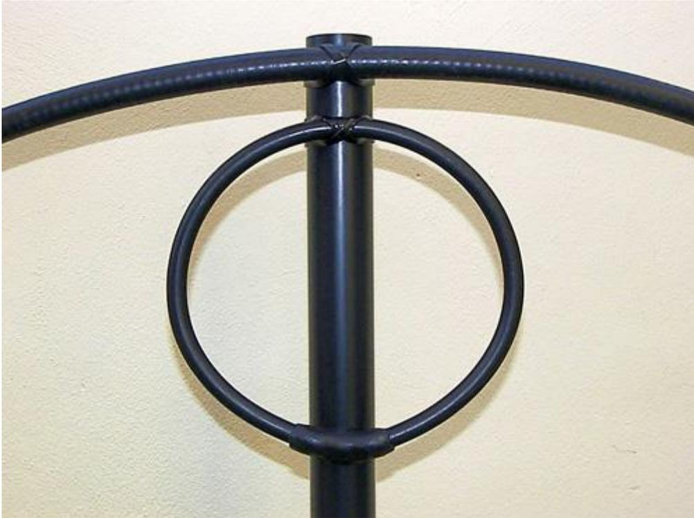
Loop interno feito com 56 centímetros de cabo coaxial RG213.
