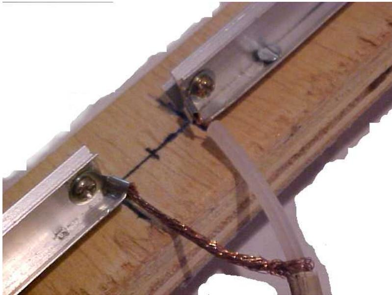
Conexão do cabo no dipolo
