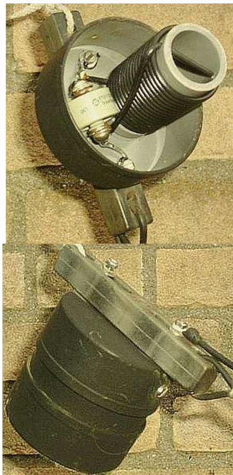
Gemakkelijk te maken degelijke sperkringen van standaard PVC materiaal.
