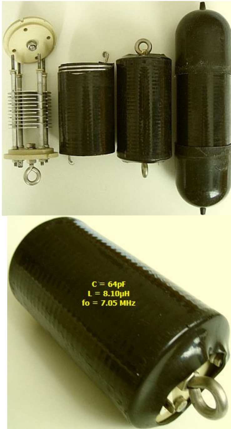
Links: de constructie en opbouw van een originele FRITZEL trap; rechts: een complete trap zonder kappen.
