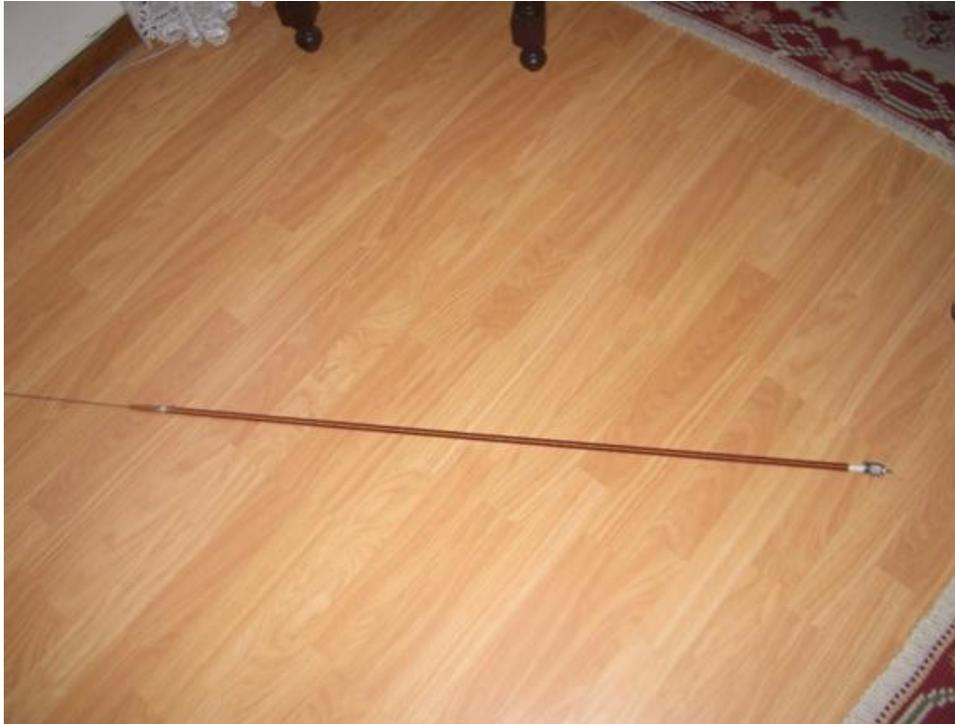
Antena com a ficha PL colocada na base, com a péça de latão posta na parte superior para afinação da frecuencia de tx, enrolamento espiras de fio á volta do tubo de fibra de 8m/m de diametro
