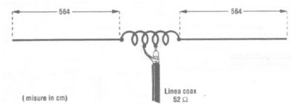
Bobina: Tubo com diâmetro de 6cm com 30 espiras de fio de 2mm
