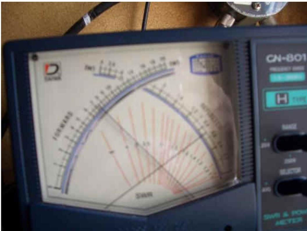
**Ilustração 8** - 750 WATTS 1.3 SWR 7.099 MHZ
