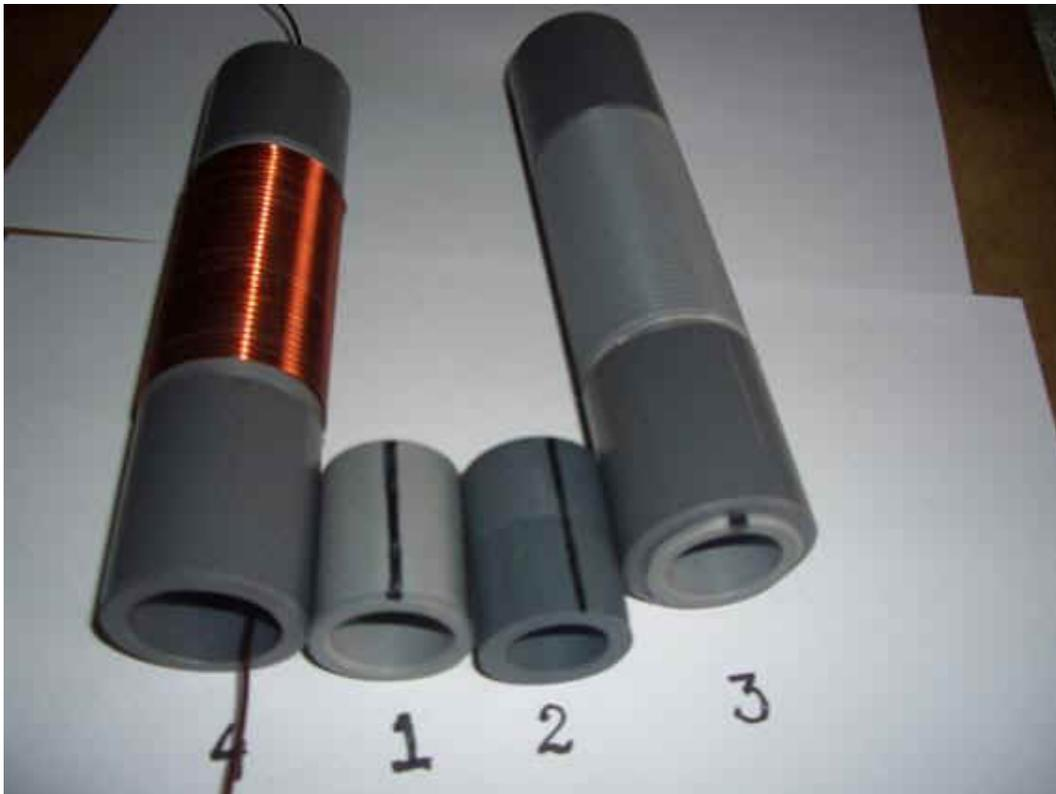
**Ilustração 3** - CASQUILHOS 1 e 2 de 20 e 25 m/m, bobina já com enrolamento fio 1,6 e uma sem o fio,
