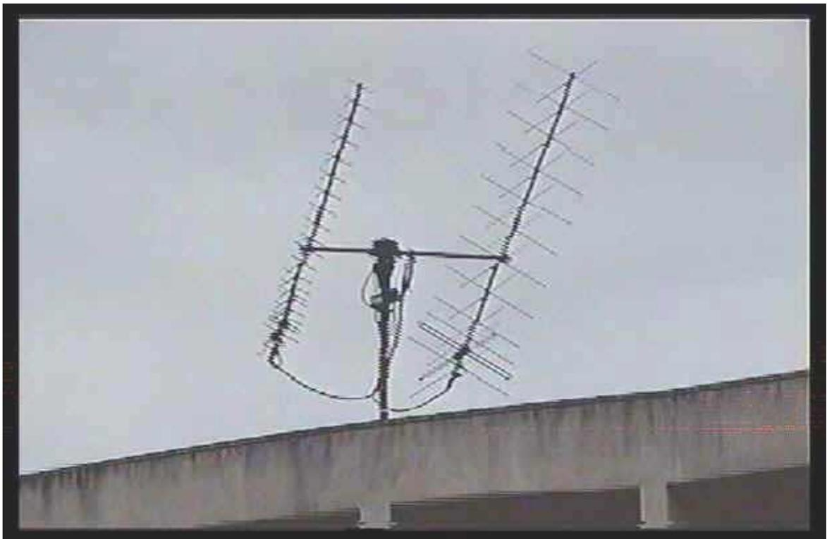
**Ilustração 20** – Antenas de VHF e UHF cruzadas polarização axial direita para Satélite
