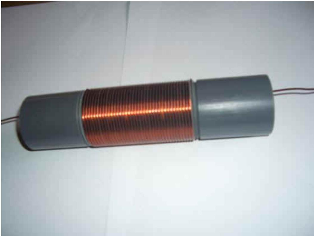
Bobina com o fio já bobinado, furo para o fio passar para o interior
