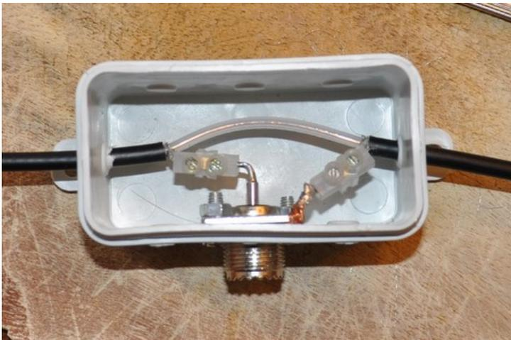
Fertig aufgebaute Verteilerdose mit PL-Buchse
