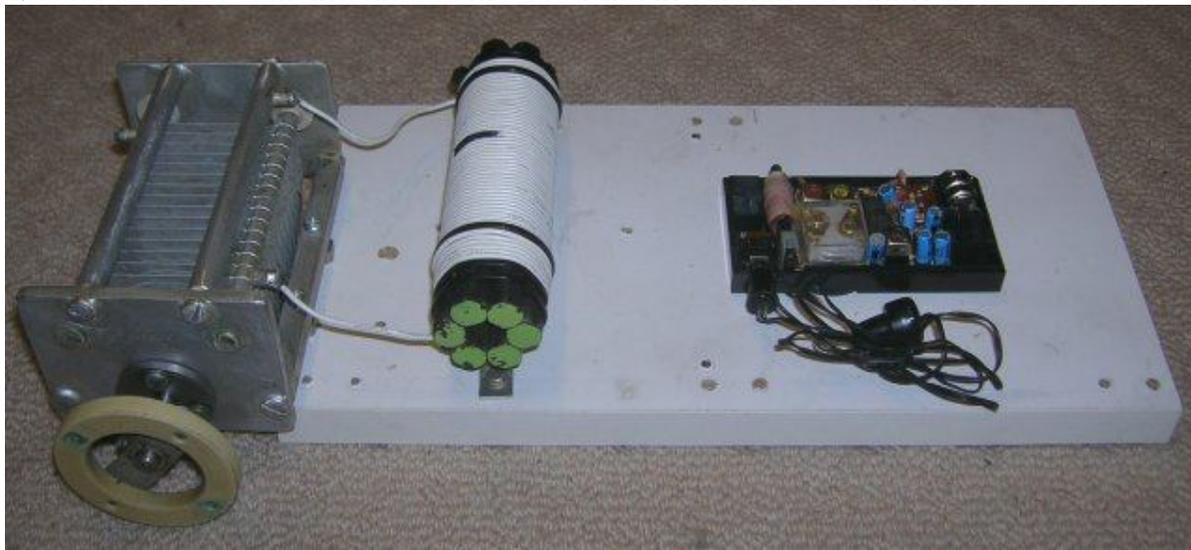
Come si puo' vedere l'antenna induttivo capacitiva e' composta da soli 3 elementi. Il condensatore variabile da 25-250 pico Farad, la bobina da 350 micro Henry e da un piano di formica di 140 x 270 mm che funge da sostegno sia al condensatore che alla bobina e con un piano libero per ospitare la radio a cui dobbiamo migliorare al ricezione.
