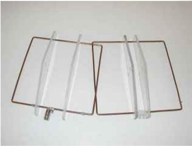
La prise BNC est préparée. On soude une languette de laiton sur la masse, puis un demi « sucre » pour l'adaptation au cadre radiateur. Ne pas oublier d'enfiler les barrettes isolantes avant le pliage du fil.
