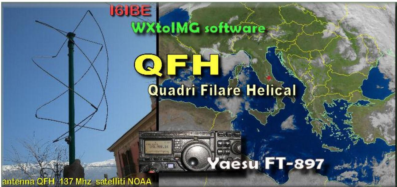
La facilità di costruzione di questo tipo di antenna, unito all'alto guadagno in RX, dopo giorni di test e paragoni con antenne simili, ha fatto sì che venisse adottata da tutti gli sperimentatori della zona. Sono stati realizzati decine di esemplari di QFH sempre con risultati positivi, l'antenna presenta un ROS 1:1 in TX sulla porzione di banda 137-138 Mhz. Il costo per la realizzazione di un esemplare non supera le 15 euro, sia se si realizza con bacchette di ottone che con tubi di rame.
