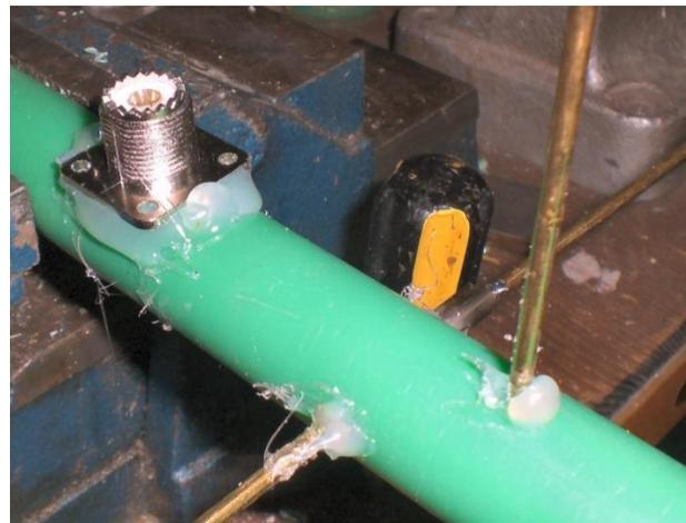
Isolatore in bachelite/vetronite (un ritaglio di circuito stampato), un bocchettone di uscita per la discesa verso il ricevitore.
