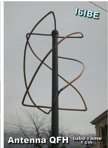
Le misure date sono quelle reali, curvature comprese, e comunque millimetro più o meno, non compromette il buon funzionamento, quindi ampia tolleranza nelle misure, per maggiori chiarimenti scaricate il files PDF originale.
