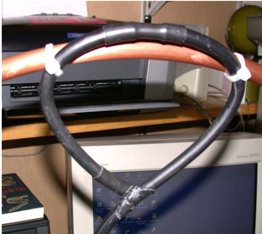
Foto 3 - Link con cavo coassiale tipo RG 213
