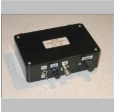
Il noto OM Finlandese Matti Ohohtola OH7SV, il progettista del ricevitore JUMA RX1, ha realizzato un'antenna in ferrite per la banda dei 40/80 metri.
