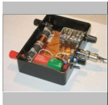
cannibalizzando un vecchio "transistor" giapponese, da cui estrarre la ferrite e il condensatorino di sintonia, poco importa se il valore delle sezioni è differente, gli altri componenti li troveremo nei nostri cassettoni.
