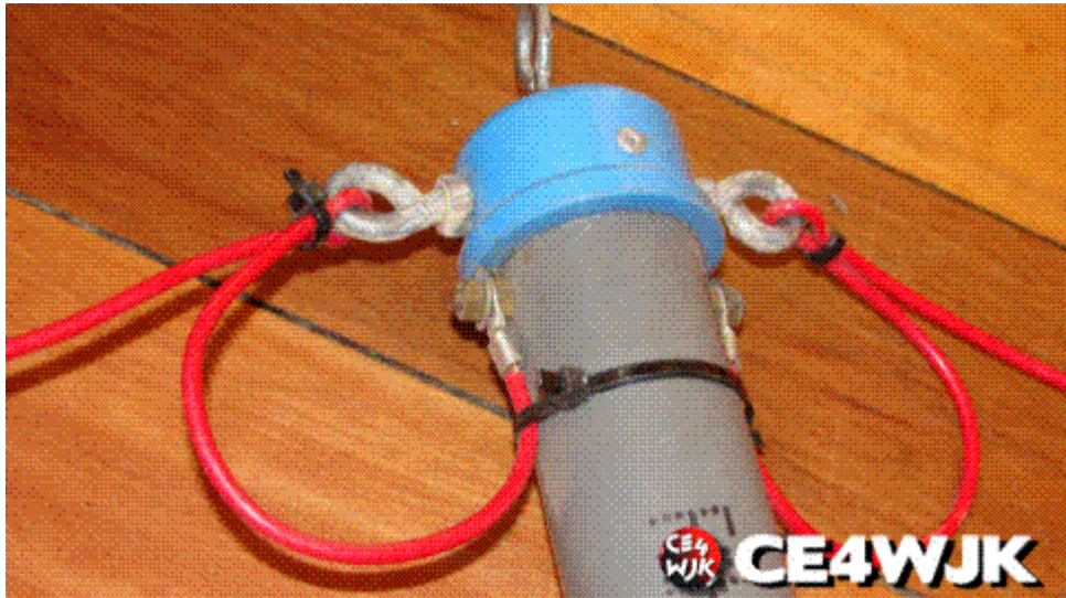
Balun 1:1 por CE4WJK listo para usarlo en una antena V invertida
