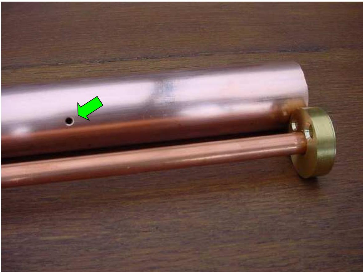
→ Este “furo”, é para soldar a malha do cabo coaxial por dentro...
