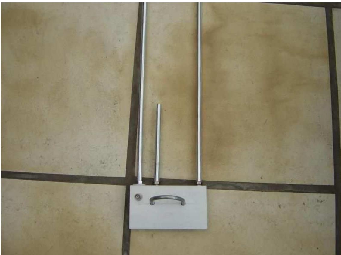
Placa de Suporte vista pela frente ( note que aqui, é um Conector do tipo “BNC”... )
