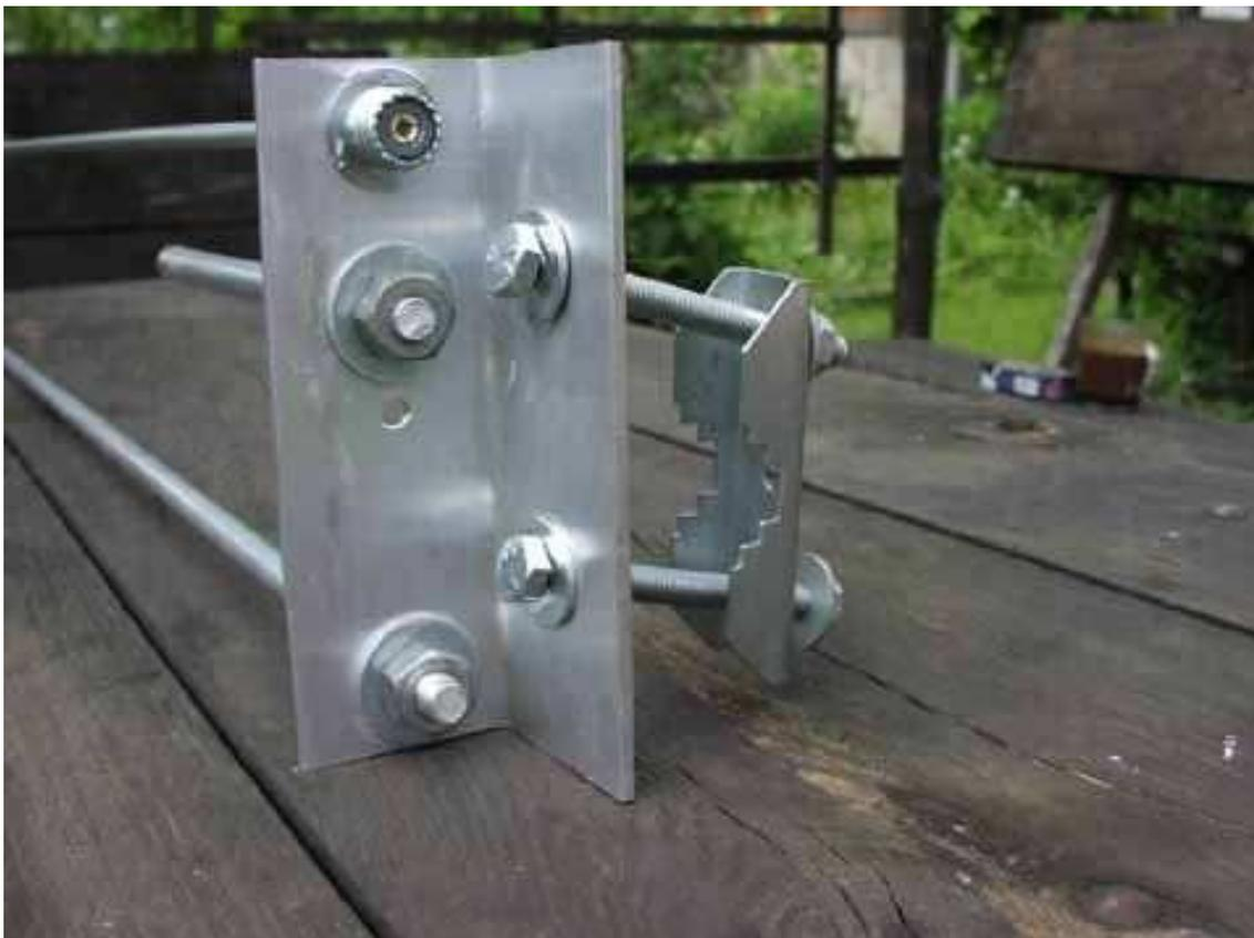
Abraçadeira do Suporte (cano) de “chapa” ( não use os parafusos de ferro ! )
