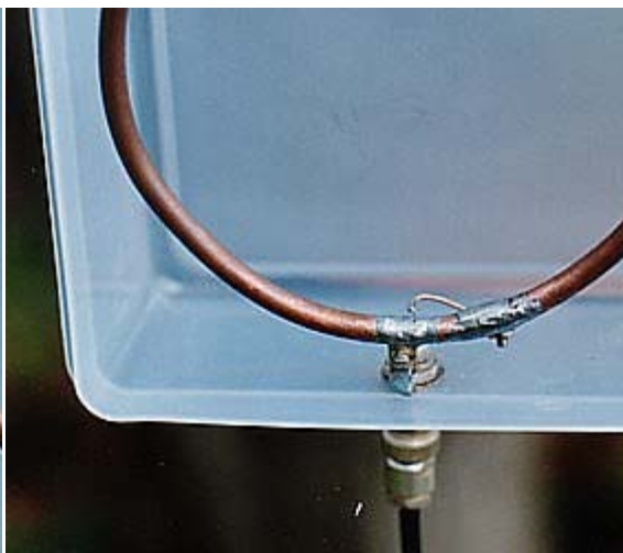
Figura 5 - O esboço de correspondência e conector BNC.
