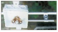
Bild 12: Praktische Ausführung der Gamma-Anpassung. Auf guten Massekontakt zwischen Buchse und Trägerrohr ist zu achten! Fotos: Autor
