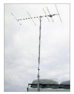
Bild 4: 5-Element-Kurzyagi (Typ 1) mit Faltdipol als Strahler
