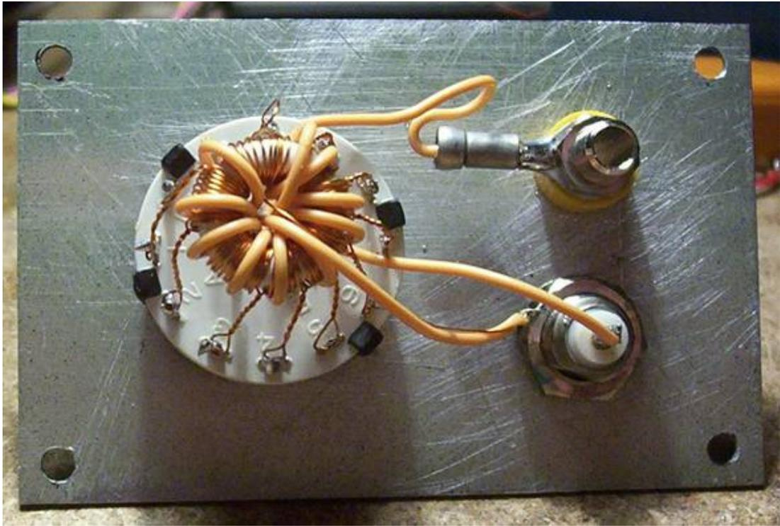
Qui lo stesso visto di fianco. Si nota il filo di uscita saldato al centrale del BNC, sulla destra.
