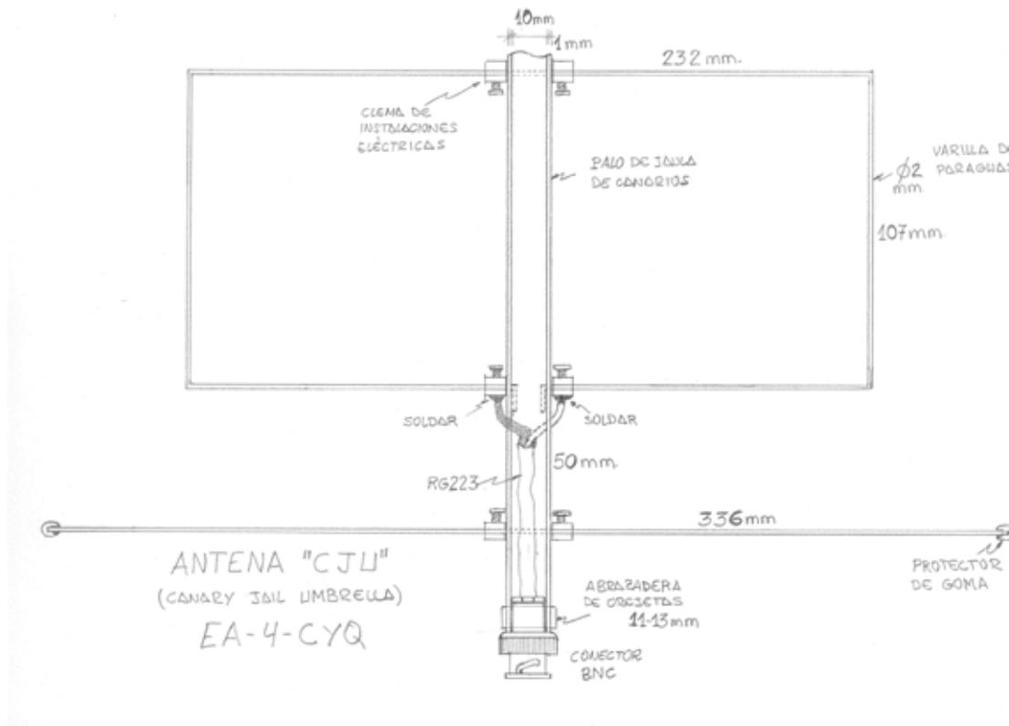
Esquema 1: Plano constructivo e la antena 'CJU'
