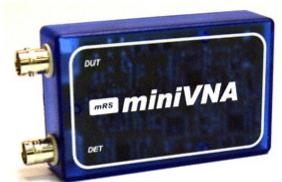
***miniVNA - um analisador de pequena antena para 0,1-180 MHz , com conexão USB para um PC***
