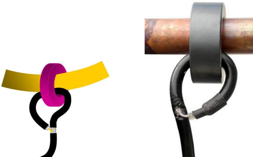
***Acoplamento com um transformador de núcleo de ferrite toroidal - coaxial loop como enrolamento secundário***
