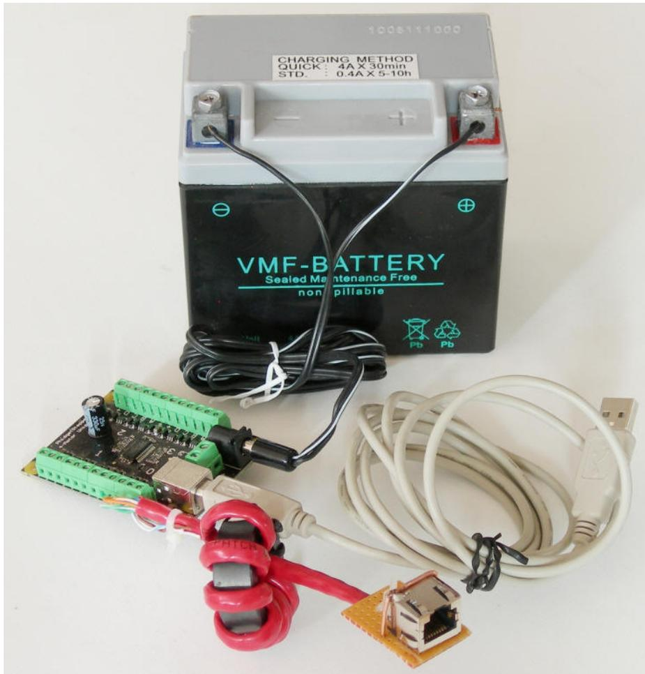
***A ferrite de estrangulamento na extremidade do cartão do cabo CAT5 ao motor***
