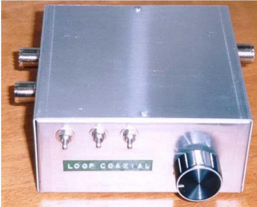
Circuito sintonizador da antena loop coaxial para Ondas Tropicais
