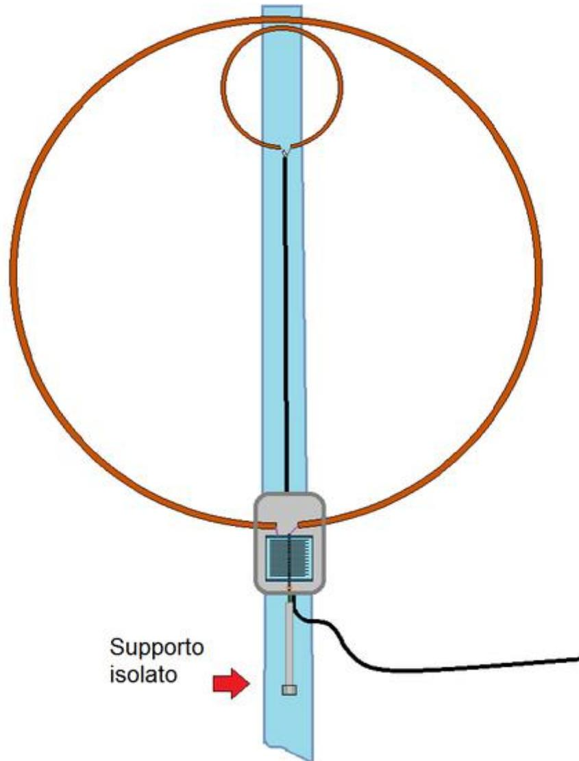
Per la presenza di tensioni elevate in questo punto, la manopola di regolazione del Condensatore variabile deve essere **BEN ISOLATA** e **DISTANTE** dallo stesso.
