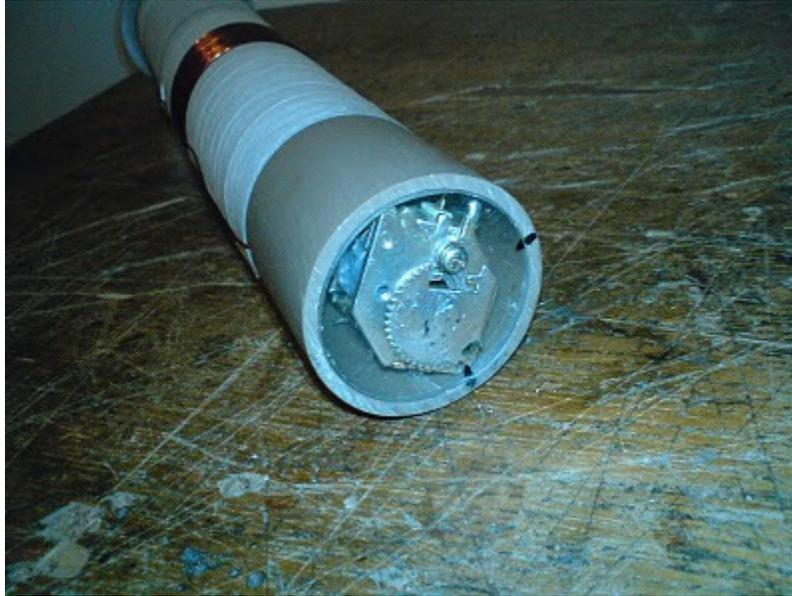
Neste lado, o capacitor fixo na tampa de acrílico, fiz duas marcas para achar o posicionamento correto da tampa na hora de fazer as furações.
