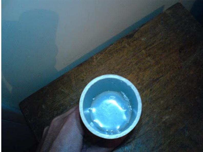
Aqui a parte interna já com o ferrite moído. Confeccionei duas tampas de acrílico, uma para fixar o capacitor variável e outra para tampar o cano. Apesar da tampa ter ficado justa eu coloquei cola quente (conheço pelo nome de patex) para mais segurança.
