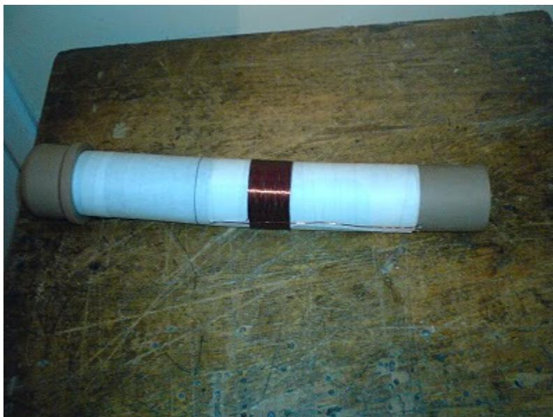
Aqui já com a bobina. No esquema fala para usar fio 18 ao 22AWG, eu usei 23AWG, mas não ficou centralizada como queria.
