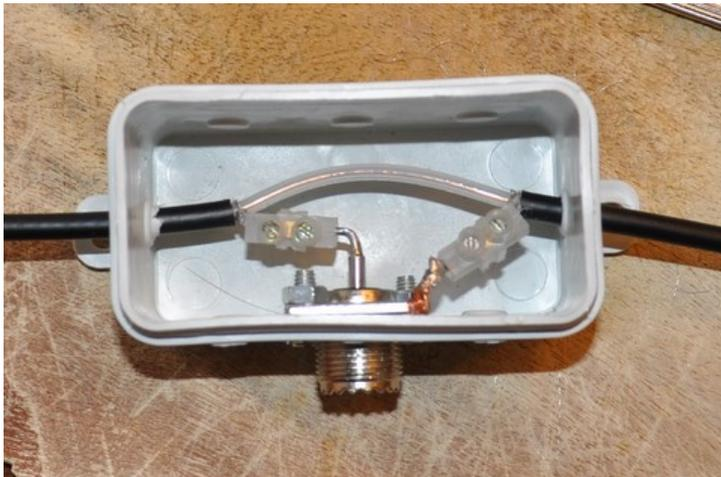
Fertig aufgebaute Verteilerdose mit PL-Buchse
