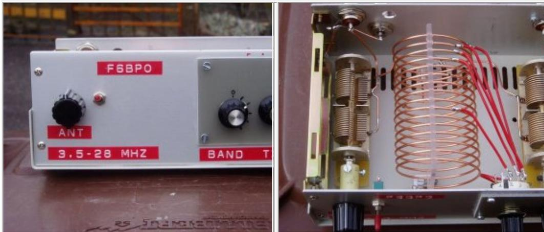
La comparaison des deux photos permet de faire la relation avec le schéma de câblage. Les CV sont isolés de la masse et la commande de leur axe se fait au travers d'un manchon isolant. La sorte antenne se fait soit sur une prise coaxiale, soit sur une fiche banane selon le type d'antenne utilisé.
