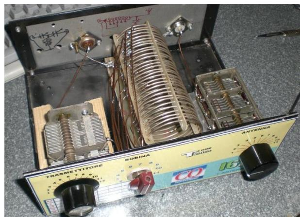
Il risultato è accattivante e per nulla male, ovviamente potrete personalizzarlo con il vostro nominativo o con loghi a voi congeniali. La potenza RF che il tuner regge o supporta, dipende esclusivamente dai condensatori variabili, o meglio dalla spaziatura delle lamelle e dal commutatore, la bobina è sovradimensionata, e comunque fino a 400 watt non dovrebbe dare problemi, con condensatori adatti, magari sottovuoto si supera facilmente la soglia del KW.
