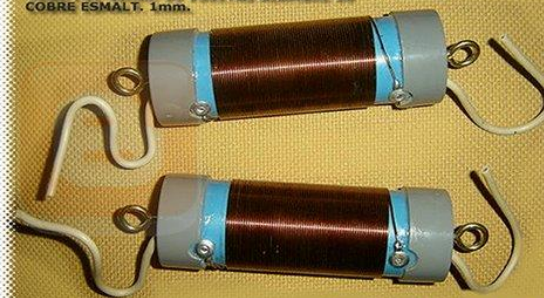
2 BOBINAS DÍPOLO 40-80 MTS. TUBO PVC 40mm, 65 VUELTAS ALAMBRE DE COBRE ESMALT. 1mm.
