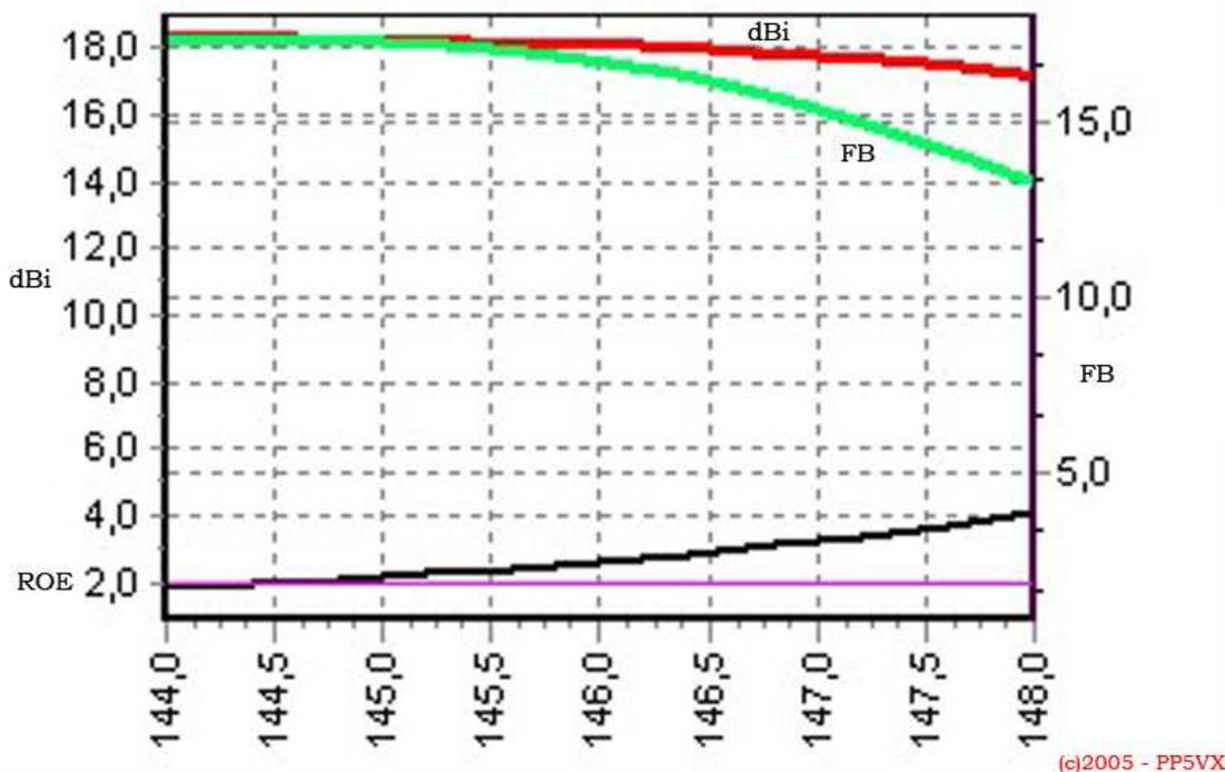
Existem métricas adequadas para a medida de eficiência de uma antena, porém observe atentamente que esta métrica **não é somente** uma **ROE baixa**.
